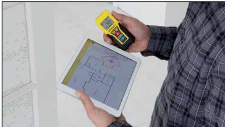
Le misure vengono trasferite automaticamente nella planimetria.
