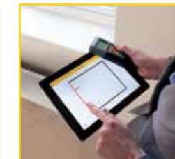
Sincronizza il misuratore TLM 99s - TLM 99si con l'App STANLEY Floor Plan per prendere velocemente le misure, realizzare e salvare le planimetrie. La connessione Bluetooth® consente di mettere subito in pianta le misurazioni rilevate.
